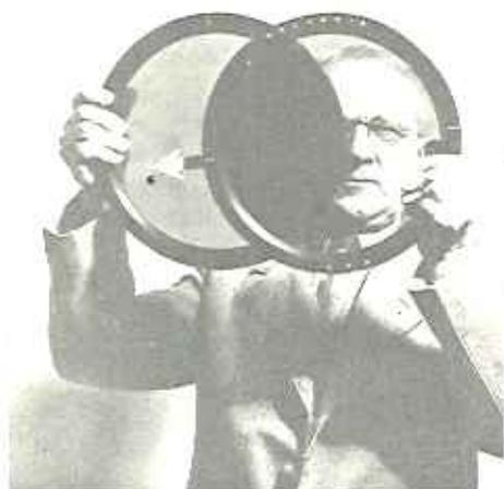
1. Come avviene l'estinzione della luce attraverso due vetri polarizzatori orientati di 90° rispetto ai segni di riferimento.
